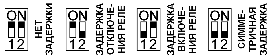
Рис. 5. Внутренние переключатели датчика.
