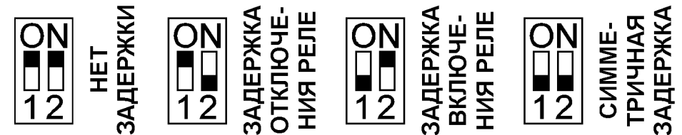
Рис. 5. Внутренние переключатели сигнализатора.
