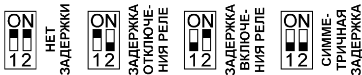
Рис. 6. Внутренние переключатели датчика.
