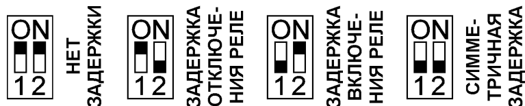
Рис. 6. Внутренние переключатели датчика.
