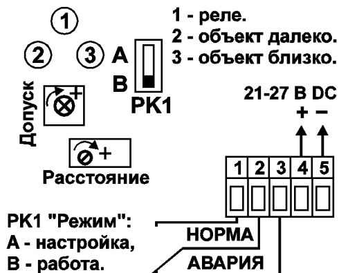
Рис. 7. Схема подключения, органы регулировки и индикации датчика.
