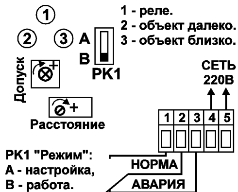
Рис. 7. Схема подключения, органы регулировки и индикации датчика.
