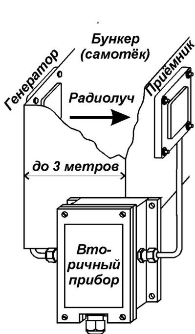
Рис. 1. Датчики РСУ-1 и РСУ-1А.
