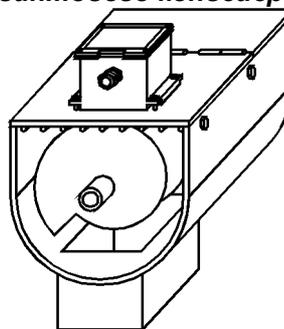
прибор устанавливается сверху над сбросным коробом, например, на крышку аварийного люка (защитная сетка не влияет на работу датчика). Зона действия уменьшается до минимально устойчивого положения. В этом случае, «не чувствуя» движения шнека через слой продукта, прибор остановит механизм при подпоре. Аварийная остановка последней секции шнека (обрыв соединительной муфты или одной из фаз) так же вызывает срабатывание датчика.
