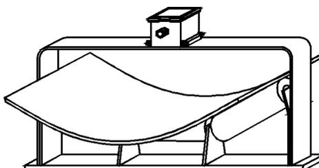
датчик располагают над рабочей веткой конвейера. Любой продукт отражает радиосигнал гораздо лучше гладкой резиновой ленты. Зона действия снижается до такого положения, при котором прибор не реагирует на порожнюю ленту, а срабатывает только при движении ленты с продуктом.
