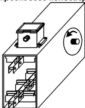
датчик монтируется на короб механизма вблизи привода. Прибор настраивается на движение верхней ветви цепи: его чувствительность снижается до минимально устойчивого положения. Обрыв цепи приводит к её провисанию в точке установки датчика, выходу из зоны действия и отключению конвейера.
