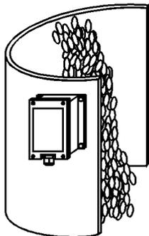
датчик устанавливается в отверстие на продуктопроводе. Наличие внутри движущегося материала приводит к изменению выходного сигнала прибора.
