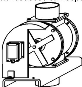
на его вал крепится крыльчатка. Если затворы объединены в группу и имеют общий вал, крыльчатка монтируется на последний механизм группы. Прибор устанавливается снаружи на защитный кожух механизма.
